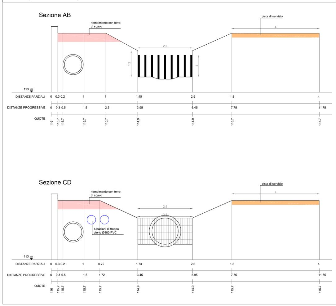
Particolare di collegamento con funzione di troppopieno tra pozzetto esistente e pozzetto di nuova realizzazione - 1:25
