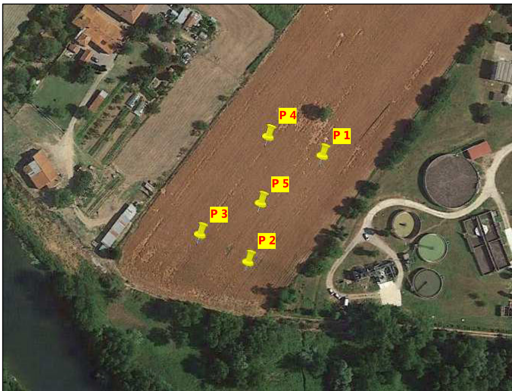
Ubicazione prove penetrometriche
